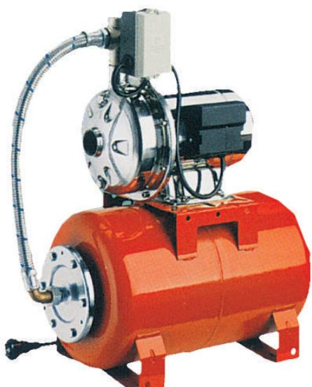
JES-JE-CD-JESX-JEX-CDX ve MATRIX serisi pompalar kullanılarak, 24 litrelük dikey genleşme tankı ile beraber komple hazırlanmış paket ünitelerdir. Ünite elemanları: pompa ve üzerinde 24 lt dikey genleşme tankı, 5 yollu bağlantı elemanı, manometre, elektrik bağlantısı yapılmış basınç şalteri, 1,5 m fişli kablo.
