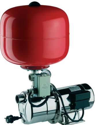
JES-JE-CD-JESX-JEX-CDX ve MATRIX serisi pompalar kullanılarak, dikey genleşme tankı montajı yapılabilecek şekilde hazırlanmış paket ünitelerdir. Ünite elemanları: pompa, 5 yollu bağlantı elemanı, manometre, elektrik bağlantısı yapılmış basınç şalteri, 1,5 m fişli kablo.
