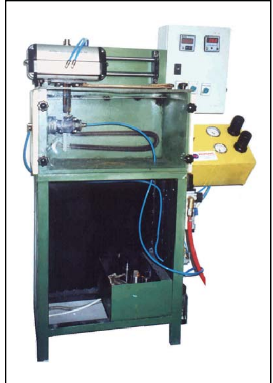
Gaz Küresel Vanaları Test İstasyonu
